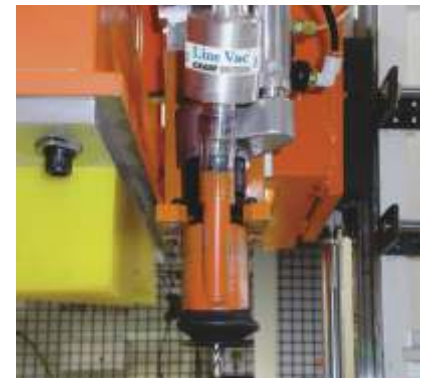
Un Line Vac aspira simultáneamente las Virutas en un proceso de agujereado
