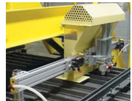
Un Line Vac aspira y rechaza casquillos de lámparas defectuosas hacia un contenedor de scrap
