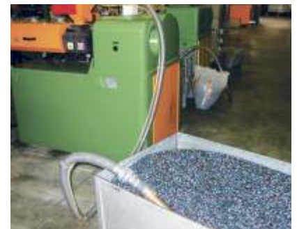
Line Vac Mod. BP6083 en una aplicación de carga de tolva con pellets de plástico
