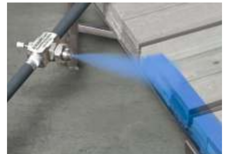
La Boquilla de Patrón Circular, modelo AN1010SS, es utilizada para marcar planchuelas de acero virgen a la salida de la fundición
