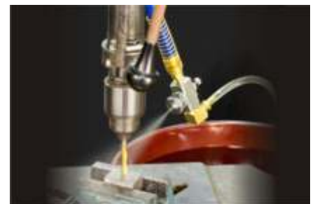
La Boquilla tipo sifón, modelo SR1010SS, se encuentra aplicada en la alimentación de líquido refrigerante en una operación de perforado
