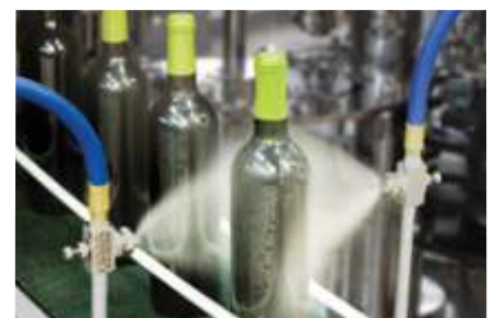
Dos Boquillas, modelo EB1030SS, se utilizan para un enjuague sanitario final antes del etiquetado de botellas de vino
