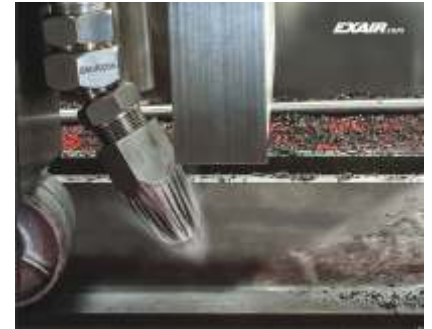
Ejemplo de Aplicación de una Boquilla de Soplado + Rótula Giratoria
