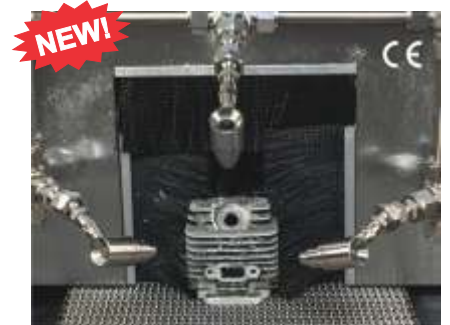
Jets de Aire de Acero Inoxidable ( NUEVOS! ) secan una pieza a la salida de un proceso de lavado
