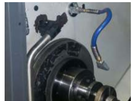
Ejemplo de Aplicación de una Boquilla de Soplado + Manguera con Memoria + Base Magnética de 1 salida
