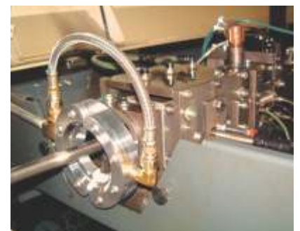
Una Cortina elimina la posibilidad de humo durante un proceso mecánico, limpiando el aceite hidráulico de la barra, mientras ésta ingresa en el chuck.
